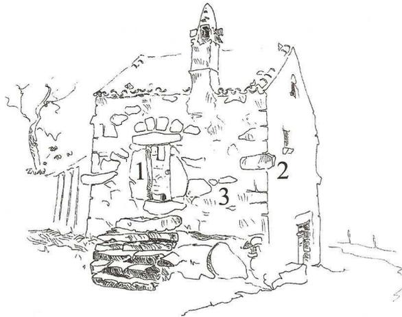
1 – Les pierres d'encadrement des portes et fenêtres et notamment les linteaux sont des éléments de structure. Dans les maçonneries anciennes, ils doivent être conservés au risque sinon de fragiliser les murs. Par ailleurs, la mise en œuvre de ces pierres présente souvent un intérêt à la fois historique et esthétique qui doit être préservé.
